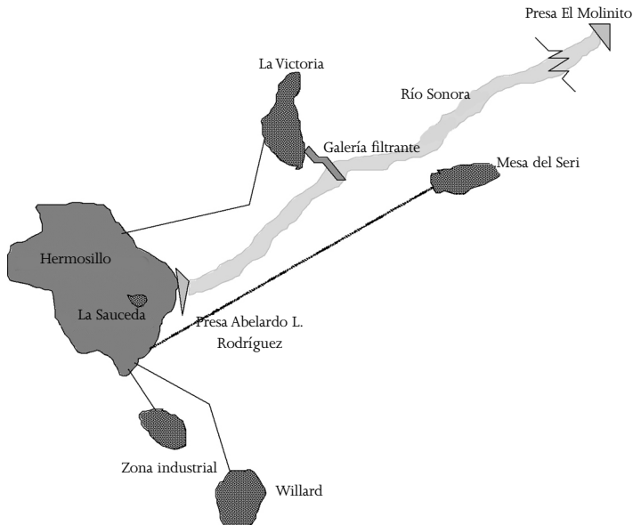
Figura 4 Sistema de suministro de agua a Hermosillo
